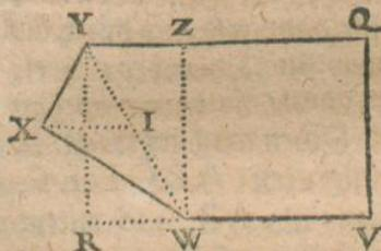
die seitten QY, WV, (parallell.) vnd mit der perpendicular lini WZ gemessen sein / darnach von der lini YW, gegen dem winckel X durch die 13<sup>te</sup> proposition eine lini abgesteckt / das der winckel XIW gleich sey / dem winckel YWV, vnd dieselbe lini XI gemessen / als dann die drey lengten
